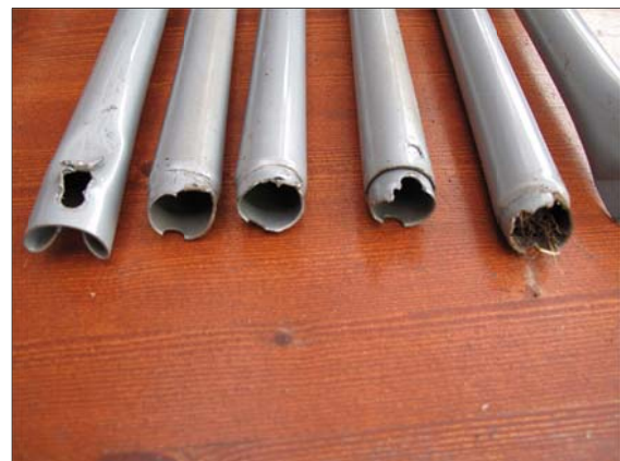
Abbildung 5: Dünnwandiges Material ist vollständig zerrissen.
