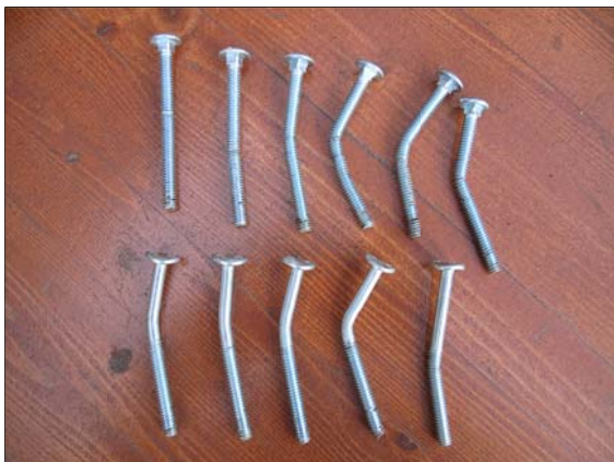
Abbildung 7: deformierte Schrauben der Firstverbindung.
